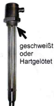
Rundflansch-Rohrheizkörper mit eingedrehter Dichtungsnut. Lieferbar mit Schraubklemmen oder Anschlusslitzen (Glasseidenummantelt oder Siliconummantelt). Aus Werkstoff Edelstahl , und Titan auch mit Überwachungs-Fühler z.B. Pt 100 oder PTC-Fühler und Einschraubheizkörper mit Hart eingelöteten oder geschweißten Rohrheizkörpern.
