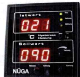
Digitaler Temperaturregler 0-150°C in Sonderanfertigung 0-400°C
