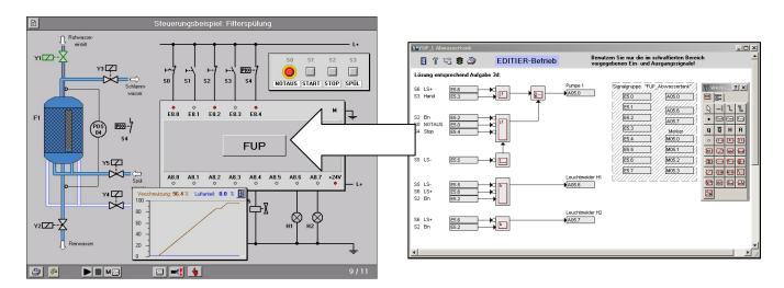
Durch Anklicken der FUP-Schaltfläche öffnet sich das Bearbeitungsfenster, in dem die Steuerungen grafisch als Funktionsplan bzw. Logikplan eingegeben werden. Zahlreiche Logikelement stehen zur Verfügung und können auf der Arbeitsfläche zur Schaltungsentwicklung genutzt werden, wie z.B.
