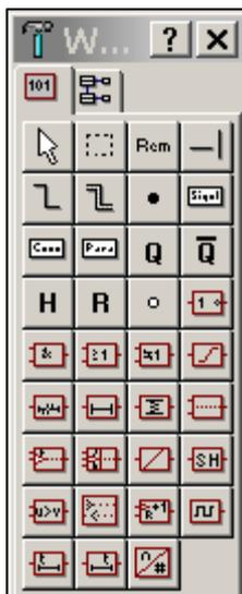
Im Logikplan-Editor werden mithilfe der Werkzeugbox die Logikpläne erstellt oder geändert.
