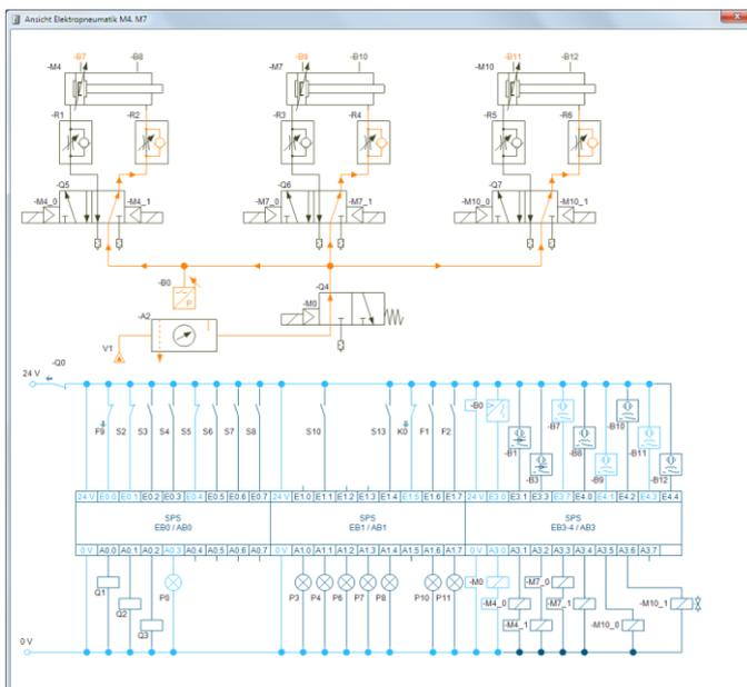
Elektropneumatische Schaltung für die Zylinder
