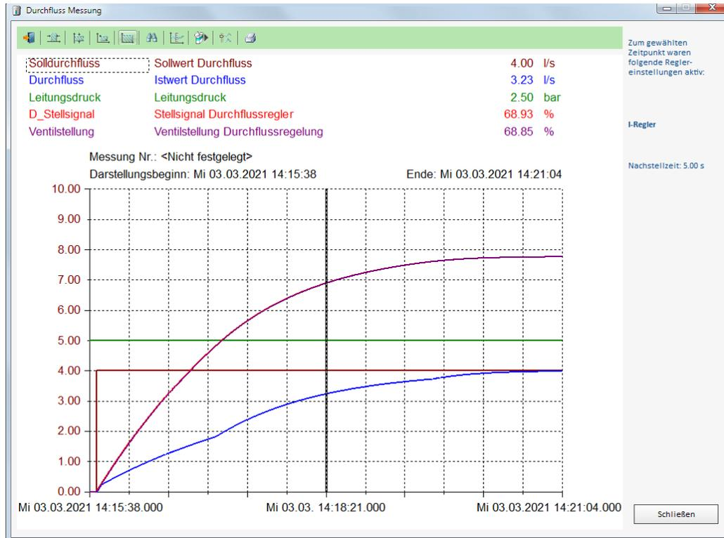
Der I-Regler ist nicht geeignet für diese Durchflussregelung, da das Einschwingen zu lange dauert.
