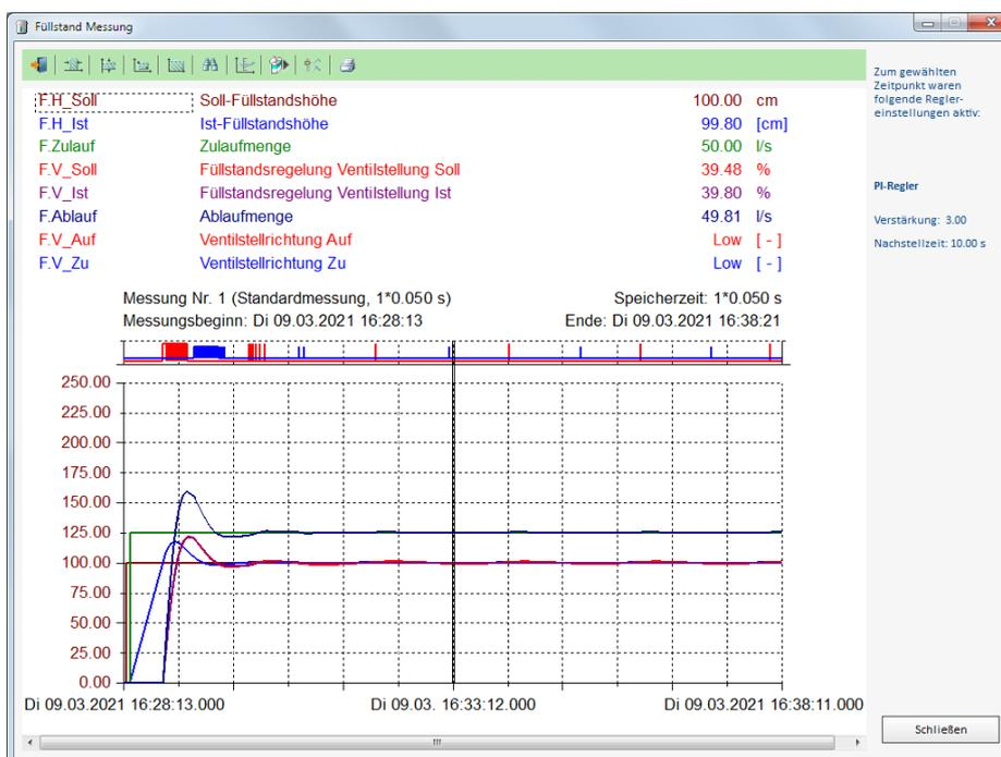
Der Istwert (Regelgröße Istfüllstand) erreicht mit dem PI-Regler und den eingestellten Parametern mit Überschwingen den neuen Sollwert (Führungsgröße Sollfüllstand).
