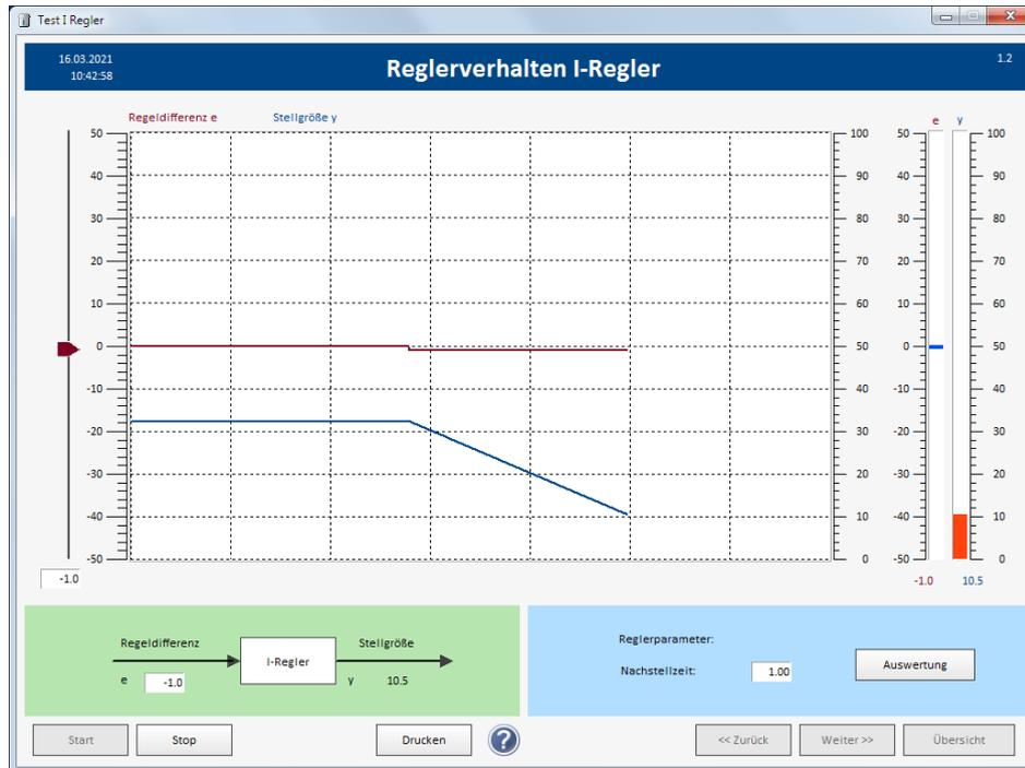
Zunächst hat der Eingang e des Reglers den Wert 0 und der Ausgang y ist konstant. Nachdem der Eingang e auf -1 gesetzt wird, fängt der Ausgang y an zu fallen. Er fällt konstant mit der Steigung -1, d.h. der Ausgang y nimmt in einer Sekunde um 1 ab.
