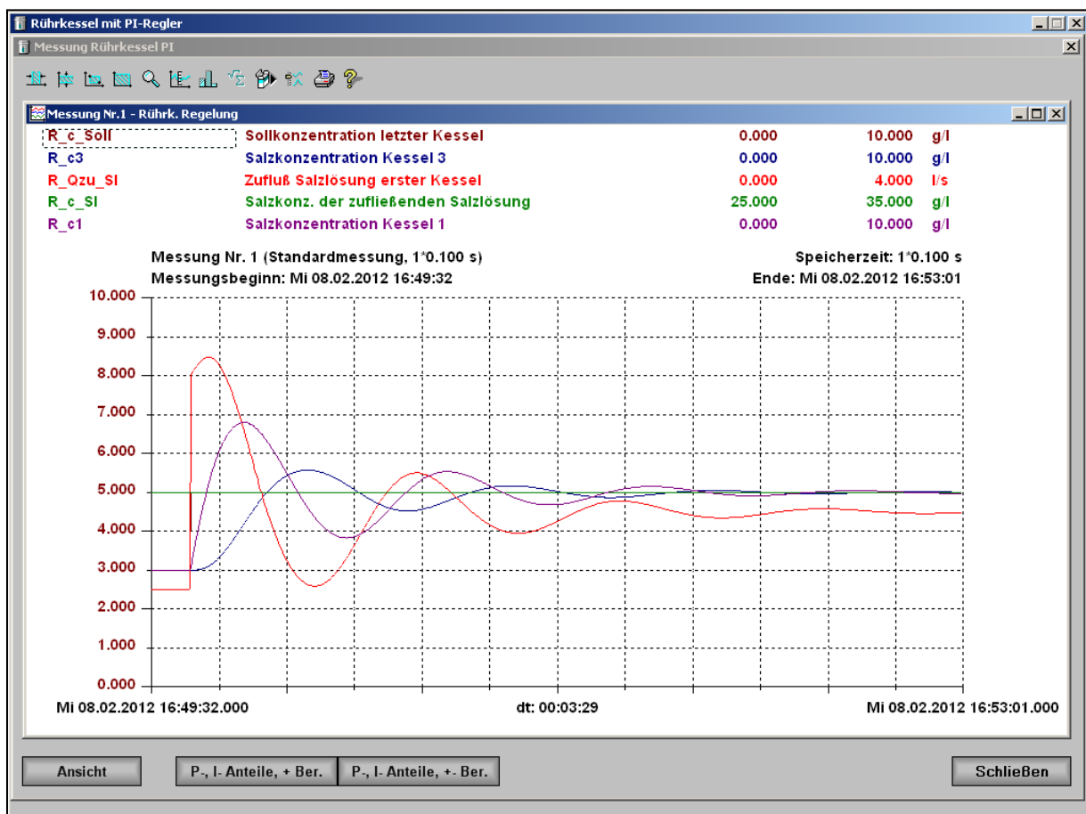
Abbildung 6-28 Führungsverhalten PI-Regler: Sprung von 3g/l auf 5g/l mit K = 1,1 und T_i (T_n) = 33,1\text{s}
