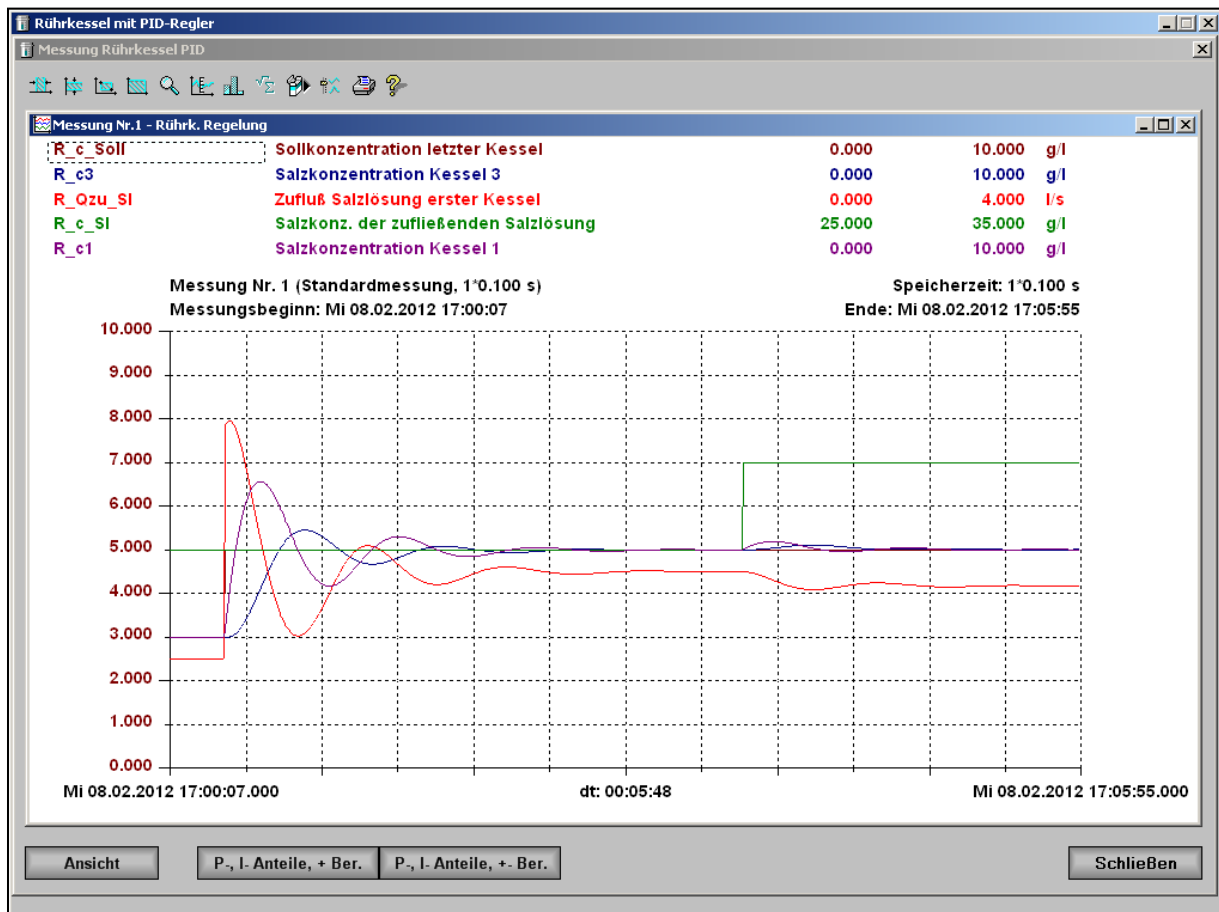
Abbildung 33 PID-Regler nach Chien/Hrones/Reswick für Führungs- und Störsprung
