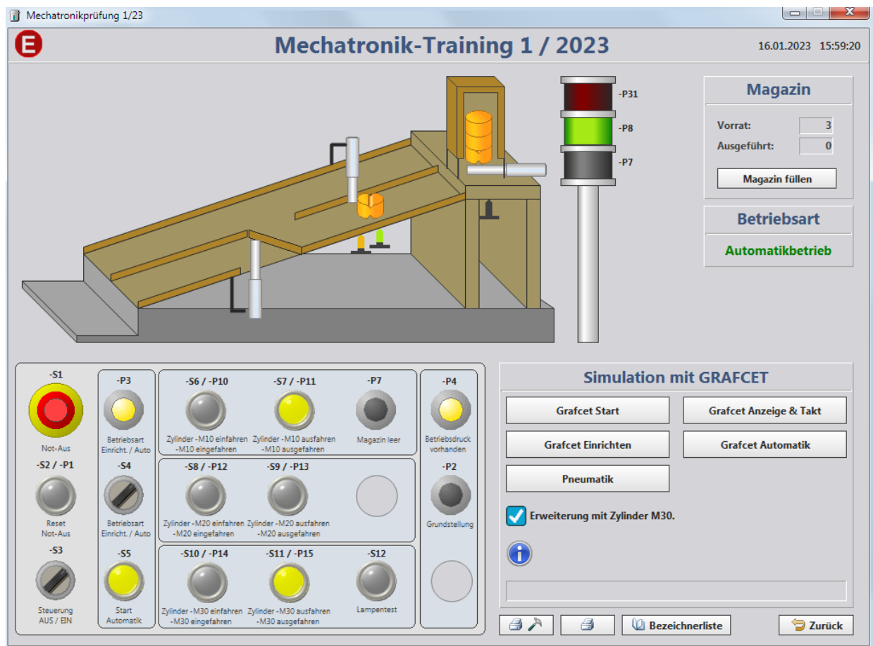
Abb. 2: Simulierte Anlage mit Bedientableau, Auswahl der GRAFCET-Pläne
