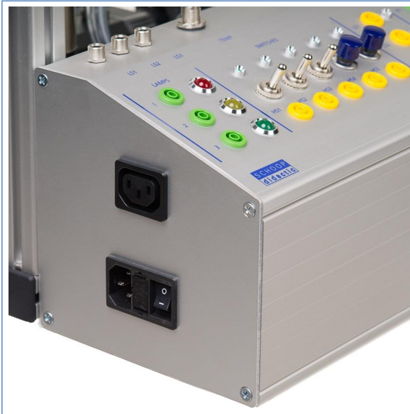
Abbildung 7: Netzanschluss und Anschluss für den Heizstab
