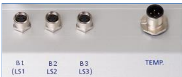
Abbildung 8: Anschluss der Füllstandsschalter und des Pt100
